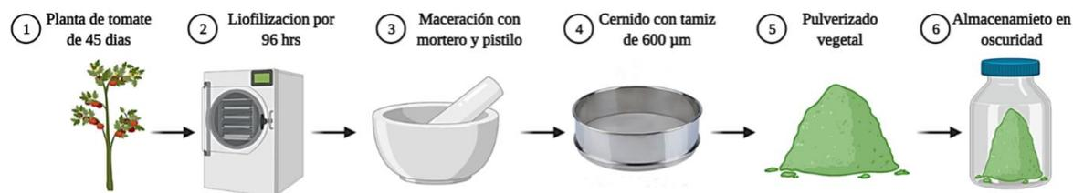
**Figura 1.** Diagrama del proceso para la obtención de tejido vegetal pulverizado utilizado como fuente única de carbono y nutrientes para el medio IPH para *Xanthomonas* spp.
